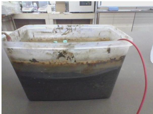
図2. 作成した微生物燃料電池
