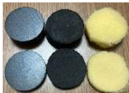
図2 左からゴム、硬いスポンジ、柔らかいスポンジ。手前が1cm、奥が2cm。
